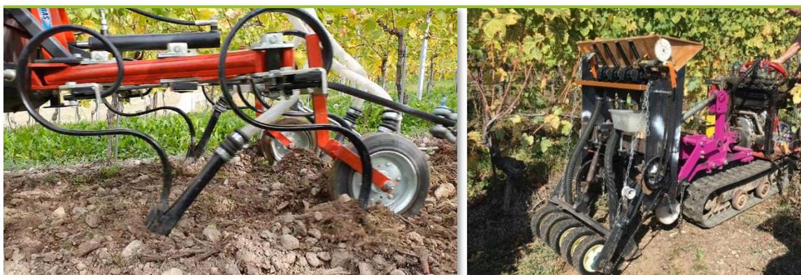
Figure 13 : A gauche, semoir derrière des griffes. A droite, semoir autoconstruit sur dents.
